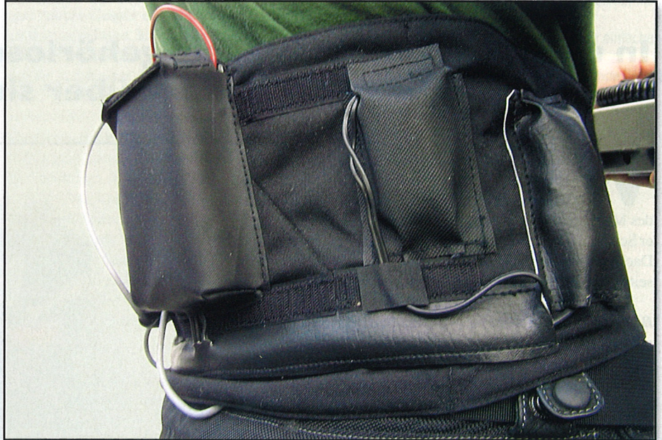
Ein funkgesteuerter Vibrator am Nierengurt. Damit können gehörlose Biker im Fahrschulunterricht Signale empfangen
